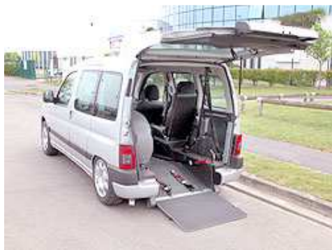
Accès passager assis en fauteuil roulant par abaissement de la suspension arrière avec une rampe
