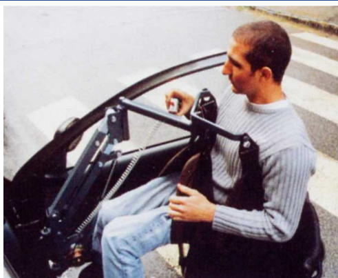
Démonstration d'un soulève personne le bras peut être démonté et fixé sur une base roulante
