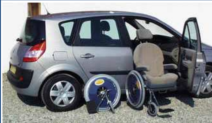
Assise pivotante, voire pivotante sortante, le siège venant se fixer sur une embase roulante.
